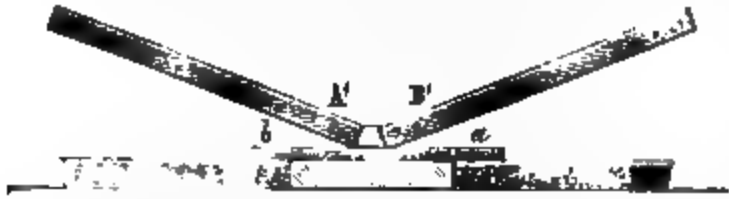
Fig. 78. — Aimantation par la méthode de la touche séparée.
