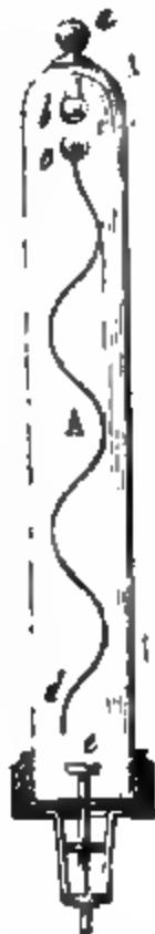
Fig. 1006. — Endiomètre à mercure.
