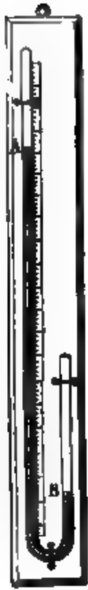
Fig. 281. — Baromètre à siphon ordinaire.
