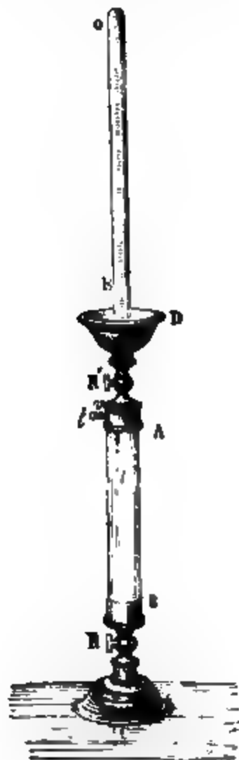
Fig. 1005. — Endiomètre de Volta.
