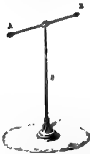
Fig. 800. — Électroscope de Dufay.
